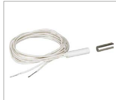
REEDKONTAKT Einfacher Reedkontakt oben in Stock und Türblattfalz eingebohrt. Rückmeldung: Tür liegt im Falz!
