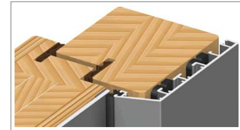
Detail - Alu-Schale Außen & drei Dichtungsebenen
