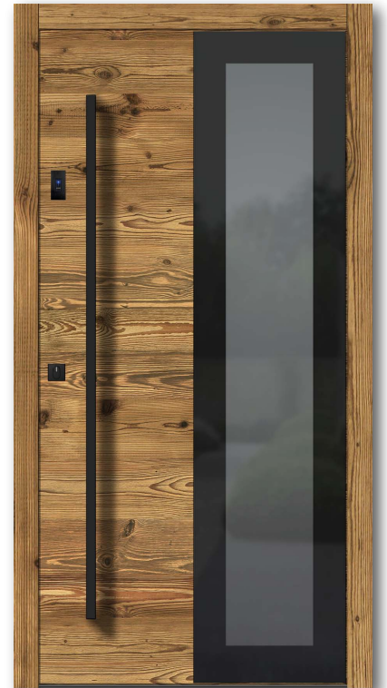
H409 Türblatt und Rahmen außen Altholz Fichte quer, Typ 3B Türblatt und Rahmen innen Fichte quer, F00 Glas Parsol grau mit Email schwarz, mittig Klarglas Außenrosette SZEP, Stoßgriff SQ160 schwarz Innendrücker GE540 Edelstahl EAV Schloss mit Fingerprint AF schwarz
